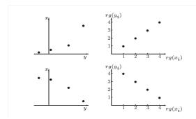
Extremfälle für Spearmans Korrelationskoeffizienten,  $r_{SP}=1$  (oben) und  $r_{SP}=-1$  (unten)
